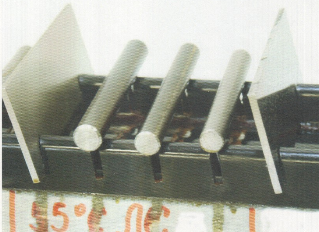
Рис.2. Внешний вид образцов с консервационным составом «Автокон» марки ЛС, нанесенным при температуре + 55 °С, после 240 часов испытаний. Коррозия отсутствует.
