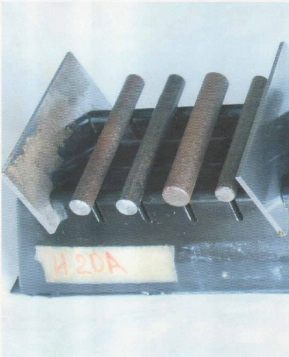
Рис.3. Внешний вид образцов с И 20А ГОСТ 20799 после 48 часов испытаний. Сплошная 100% коррозия.
